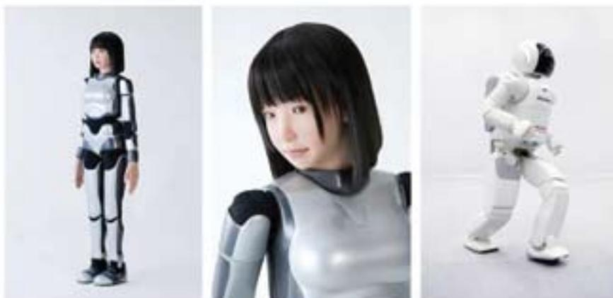
圖二 左圖和中圖：AIST的HRP-4C仿真式人形機器人，圖片擷取自[10]；右圖：HONDA的ASIMO展現跑步步態，圖片擷取自[32]
